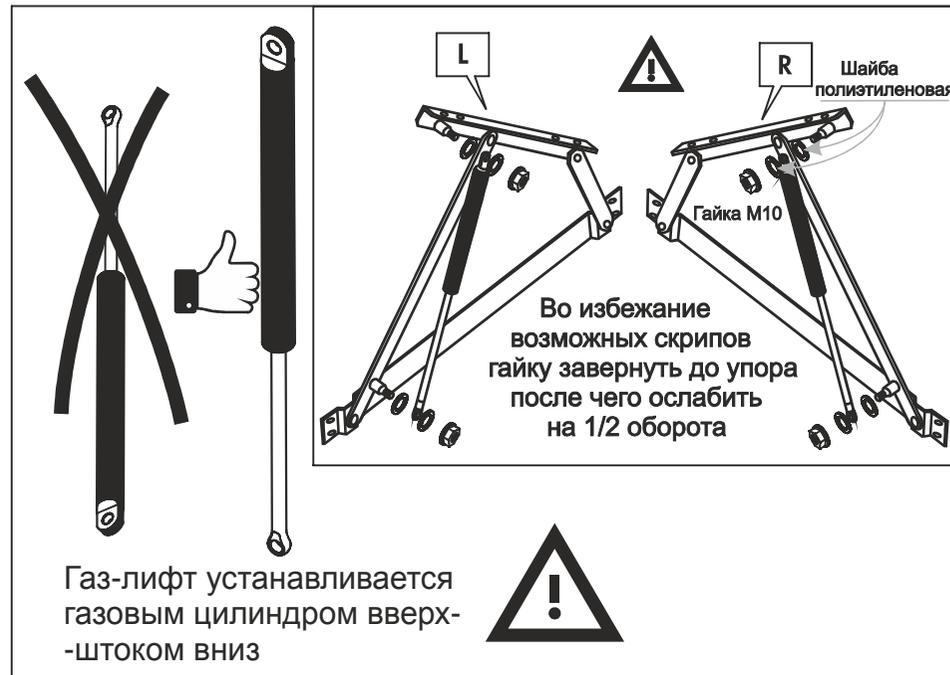
Газ-лифт устанавливается газовым цилиндром вверх-штоком вниз
